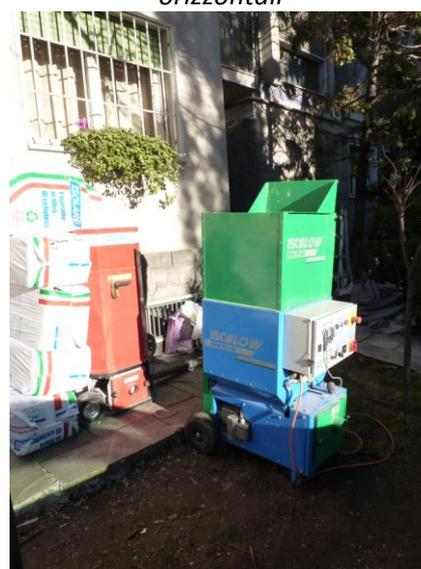
*Macchina per l'insufflaggio alla base dell'edificio e materiale isolante*
