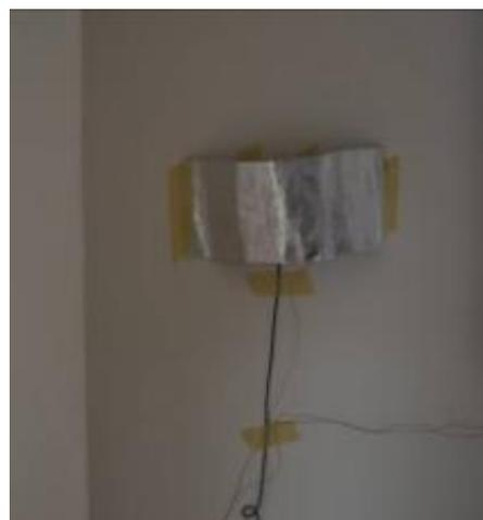
*Schermatura con materiale basso emissivo di una piastra termoflussimetrica*
