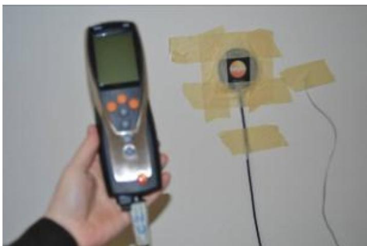
*Immagine esempio di una piastra termoflussimetrica e una sonda di temperatura superficiale e di temperatura ambiente (in dotazione al datalogger)*
