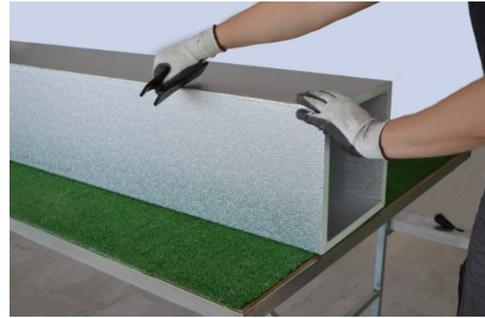
Con l'apposita spatola rigida si comprimono gli spigoli incollati per far aderire la colla.
