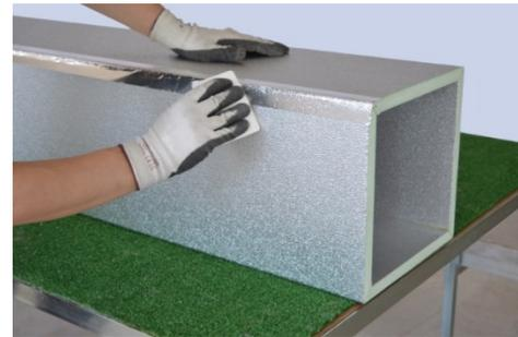
in corrispondenza delle bocche del canale si applicano i profili metallici completi delle squadrette di rinforzo, specifici per il sistema di connessione scelto. Il tutto sarà incollato con l'apposita colla per profili;
