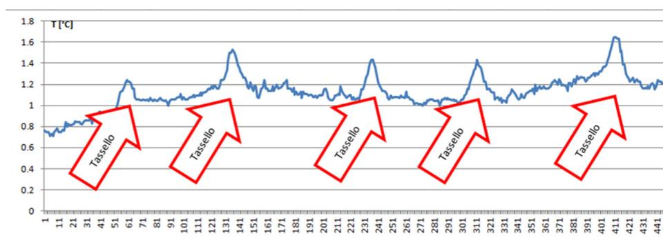
*Esempio di valutazione delle temperature superficiali con indicazione di temperature differenti*
