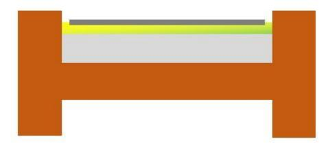
Le soluzioni sottopavimento consistono nel posare, al di sotto della pavimentazione, un materiale resiliente in grado di ridurre la trasmissione di vibrazioni e rumori.
