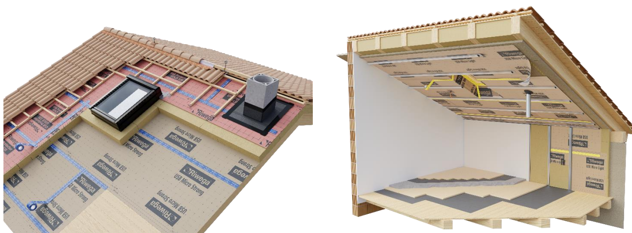
Figura 7 Esempi di stratigrafie con schermi al vapore (freni o barriere al vapore situati sul lato interno del pacchetto isolante) e membrane traspiranti (situate sul lato esterno del pacchetto isolante). Fonte: Riwega.
